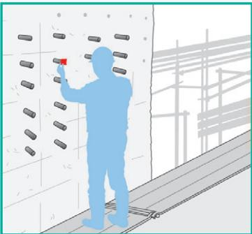
目的に合った計測用ターゲットを設置します。
